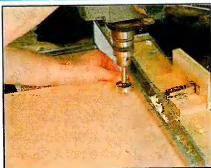
Отверстия для чашечных петель сверлят на сверлильном станке.
